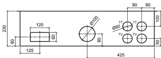
UP-Aluminiumschrank, Front roh, Seitenwände und Rückwand grundiert
