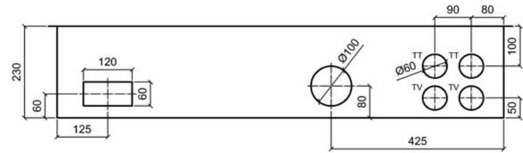
UP-Aluminiumschrank, Front roh, Seitenwände und Rückwand grundiert
