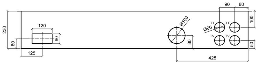
UP-Aluminiumschrank, Front roh, Seitenwände und Rückwand grundiert
